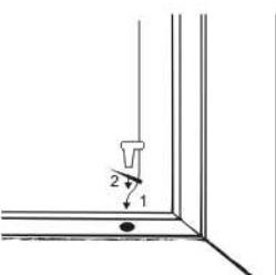
3) Za horní konec struny vypněte a přebytečnou strunu odstraníte. Potom nasadte krytku mechanizmu.
